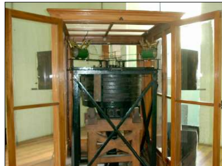
SISMÓGRAFO HORIZONTAL WIECHERT DE 1200 KILOS
