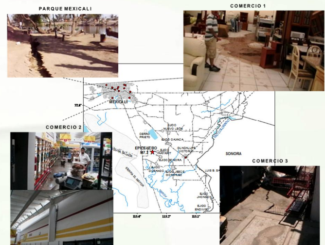
Figura 4. Algunos sitios donde se presentaron daños por licuación.
