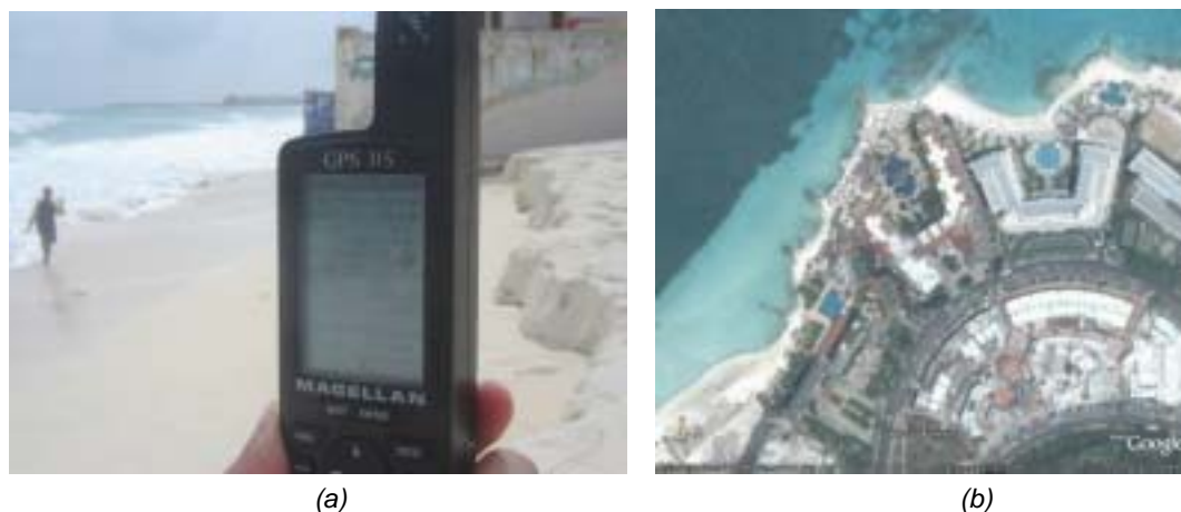
Figura 3-2 Formas para conocer las coordenadas de una ubicación: (a) dispositivo GPS (usado por ERN durante la inspección de los daños causados por Wilma) y (b) imagen de punta Cancún en Google Earth donde se aprecia que es posible fijar las coordenadas precisas de prácticamente cualquier ubicación.
